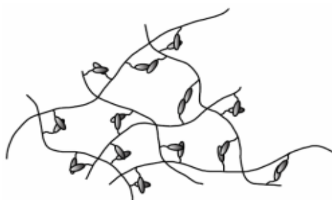
Рисунок 3. Схема пространственной сетки макромолекул ГМП (физический гель).
